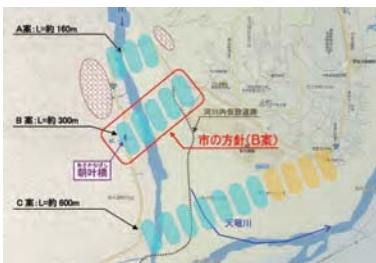
旧橋の位置から200m下流に架橋する方針が示された
